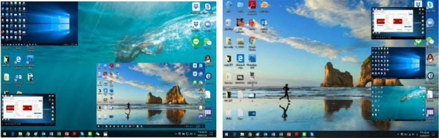
四分屏顯示可以在螢幕上同時顯示最多四台電腦的畫面，其中一台作為主顯示器，另外三台則以嵌入式視窗的形式疊加在主顯示器上，可以使用主控台滑鼠調整其大小和位置。
