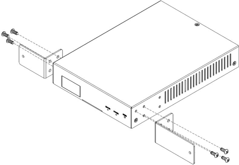
**Step 2.** 將鎖好支架的設備裝入機架框內，並使用前面板螺絲固定即可裝入機櫃內。
