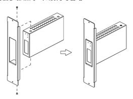
Step 4. 將鎖好支架的設備裝入機架框內·並使用前面板螺絲固定即可裝入機櫃內。
